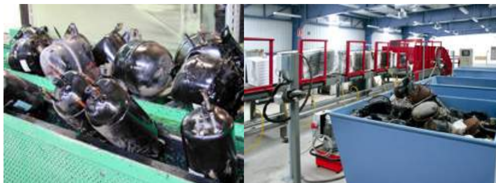
Imagen N° 7. Drenaje de las unidades selladas, o “bochas”, donde se encuentran el motor y el compresor, sobre en bateas para retirar todo el aceite potencialmente contaminado
