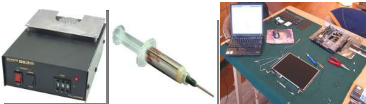
Fig. N. : Vista de equipos soldadores, des-soldadores, calentadores para trabajar y reparar contactos, plaquetas y otras piezas de los RAEE
