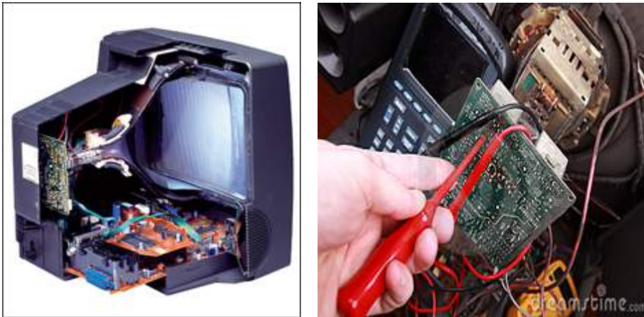
Fig. N. : Las reparaciones o reacondicionamientos de tubos de rayos catódicos, cinescopio, plasmas o telas de LCD/LED implica trabajar con altos voltajes y riesgo de liberación de material fluorescentes potencialmente contaminado con gases como el trifluoruro de carbono (NF3) es 17.000 veces más poderoso que el dióxido de carbono (CO2), uno de los principales agentes de contaminación mercurio o cadmio
