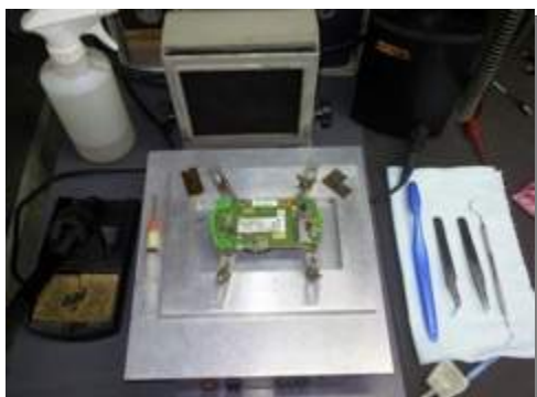
Fig. N. : Vista de área de trabajo de una plaqueta de circuito impreso, el herramental, y la colocación y soldadura de un componente discreto.
