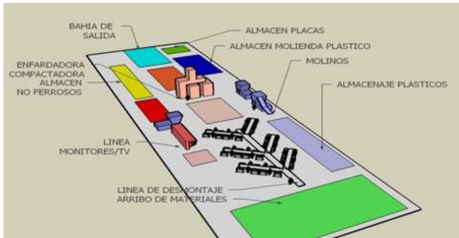
Fig. N.: Vista esquemática de una Planta Gestora de RAEE con área de ingreso de RAEE, acopio, línea de desmontaje, molinos almacenes de material procesado, línea para TV/monitores, enfardadora de metales ferrosos y expedición de reciclados.
