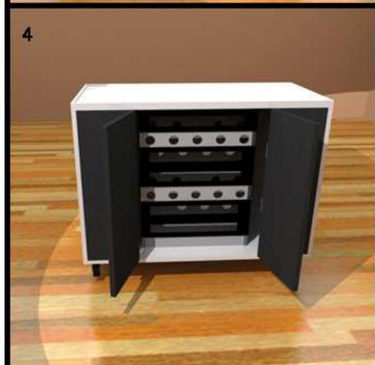
4- Módulo visto desde atrás. Mediante dos puertas se accede al rack de electricidad. Consiste en dos guías en forma de L que sostienen 5 placas de doblerrack caladas para instalar los tomas. Entre estas placas de doblerrack se coloca otra placa de MDF para no tener los cables a la vista, a la que se le hacen calados para llevar los cables del cargador al frente.
