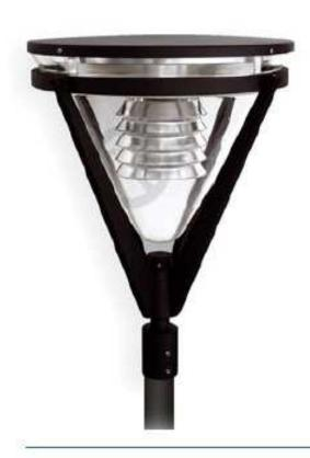
Farola de iluminación directa construida íntegramente en aluminio. Cubierta superior 2mm de espesor a continuaron se desarrolla un anillo suspendido por 4 brazos desde la base de la luminaria. Posee cómodo acceso al equipo auxiliar y lámpara a través de la cubierta superior. Difusor de policarbonato transparente de 8mm de espesor. Reflector de aluminio anodizado. Para poste de Ø 60mm.
